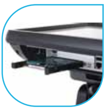
抽取式系統核心及硬碟設計，方便產品服務及升級
