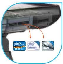
抽取式系統核心及硬碟設計，方便產品服務及升級
